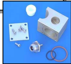
Particolare della testa del dipolo smontata Particular of the dipole's head disassembled
